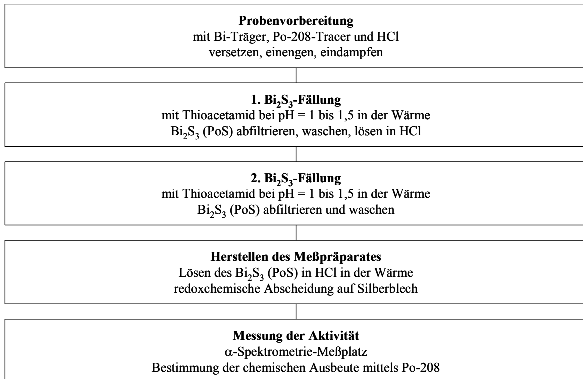
Abb. 1: Prinzip der Bestimmung von Po-210 im Trinkwasser
