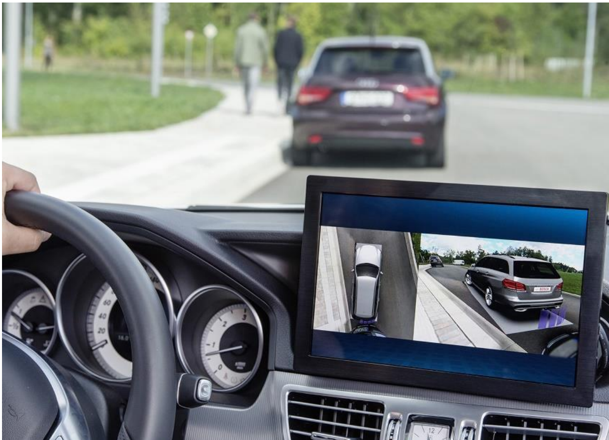
Abbildung 24: Automatische Erkennung beweglicher Objekte
