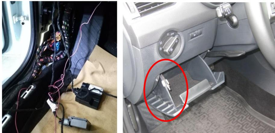
Verkabelung des Steuergeräts im Sicherungskasten (links) und fertiger Einbau des Tasters im Fahrgastraum (rechts).
