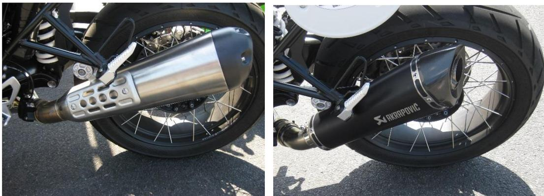
Abbildungen der zwei vermessenen Abgasanlagen. Links: Original Abgasanlage der BMW R NineT. Rechts: Ersatzschalldämpfer Akrapovic Slip-On (Titanium) für die BMW R NineT.
