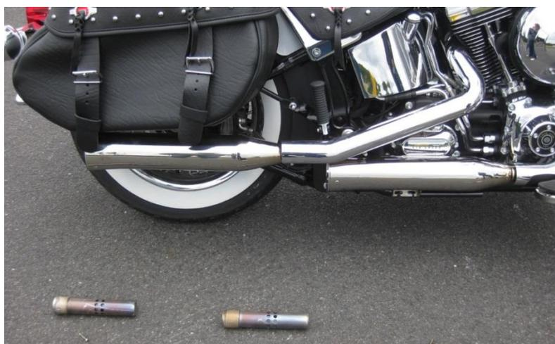
Durch den Ausbau des „dB-Eaters“ erlischt die allgemeine Betriebserlaubnis. Das Fahren des Motorrads im Straßenverkehr ist nicht zulässig und erfolgte nur zu Testzwecken auf der Teststrecke.
