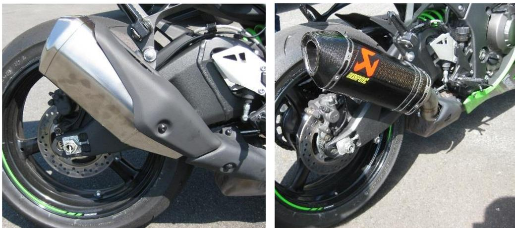
Abbildungen der zwei vermessenen Abgasanlagen. Links: Original Abgasanlage der Kawasaki Ninja ZX-10R KRT. Rechts: Ersatzschalldämpfer Akrapovic Slip-On Line (Carbon) für die Kawasaki Ninja ZX-10R KRT
