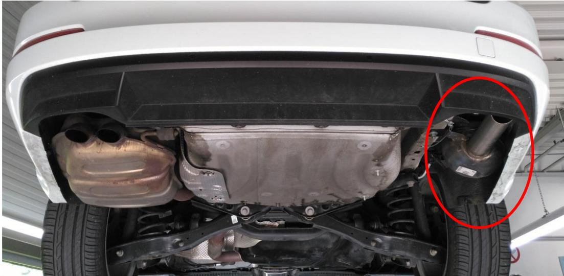
Kufatec Soundbooster im eingebauten Zustand am Testfahrzeug ohne Unterbodenverkleidung.
