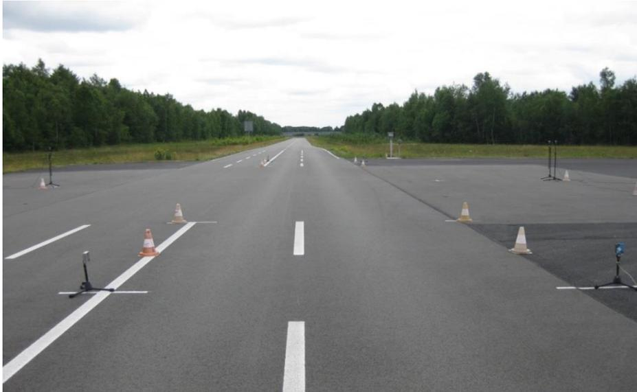
Präparierte Akustikteststrecke mit Radargerät, Mikrofonen und Pylonen zur Begrenzung des Messfeldes.
