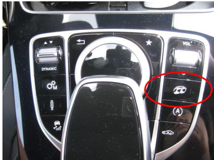
Taster in der Mittelkonsole für die Klappensteuerung beim Mercedes AMG GLC 63 S.
