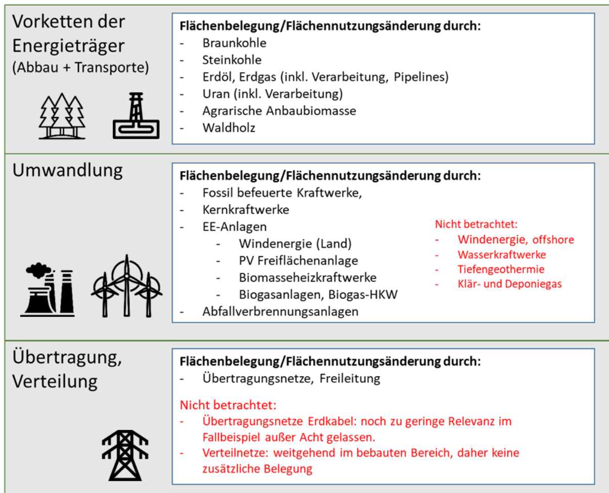
Abbildung 7: Systemraum zur Bestimmung der Flächenbelegung durch die Stromerzeugung
