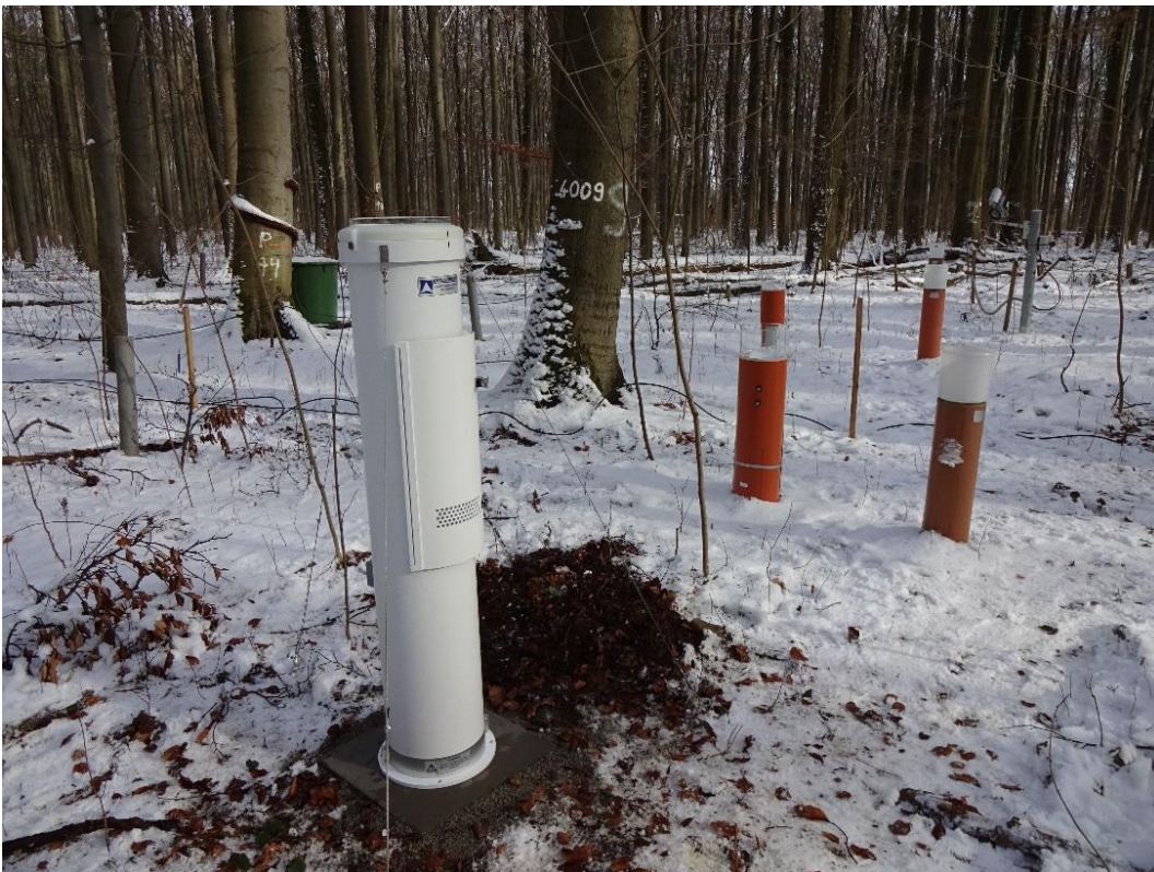
Abbildung 51: Klimatisierter Bulk-Sammler auf der Buchen-Versuchsfläche im Göttinger Wald
