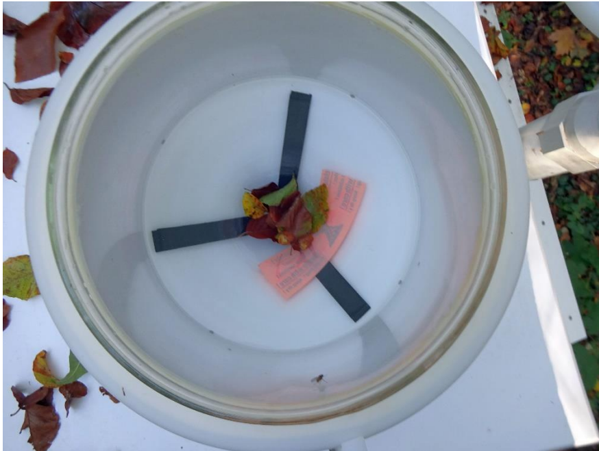
Abbildung 53: Klimatisierter Wet-only-Sammler auf der Buchen-Versuchsfläche im Göttinger Wald
