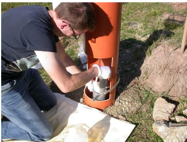
Abbildung 20: Probennahme: Einstellen des Flaschenhalters für die Trichterspülung
