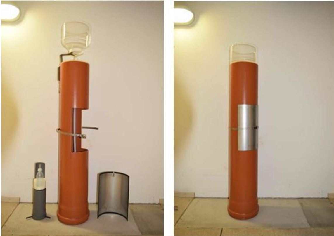
Abbildung 15: Hg-Bulk-Depositionssammler, offen mit Trichterhalter und Flaschenhalter für die Trichterspülung (links), Hg-Bulk-Depositionssammler, geschlossen (rechts)
