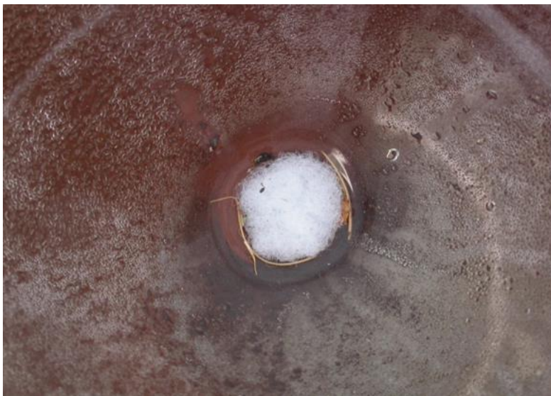
Abbildung 12: Filterwatte-Knäuel im Trichterauslauf
