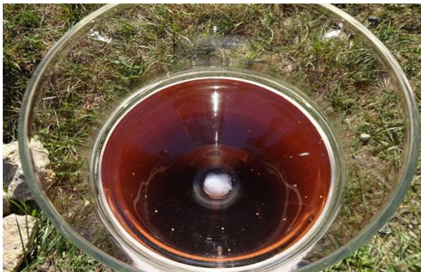
Abbildung 24: Sammlertrichter mit Filterwatte im Trichterauslauf
