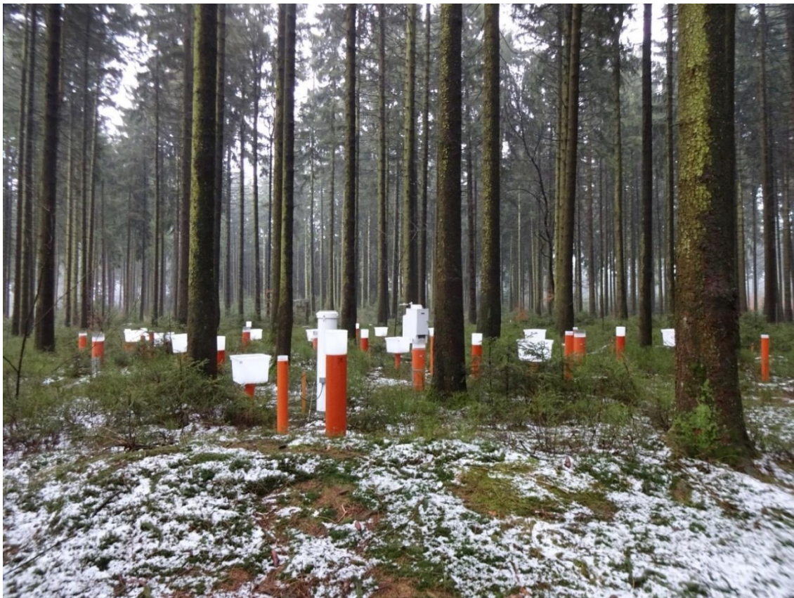
Abbildung 44: Hg-Sammler auf der neuen Fichten-Versuchsfläche im Solling
