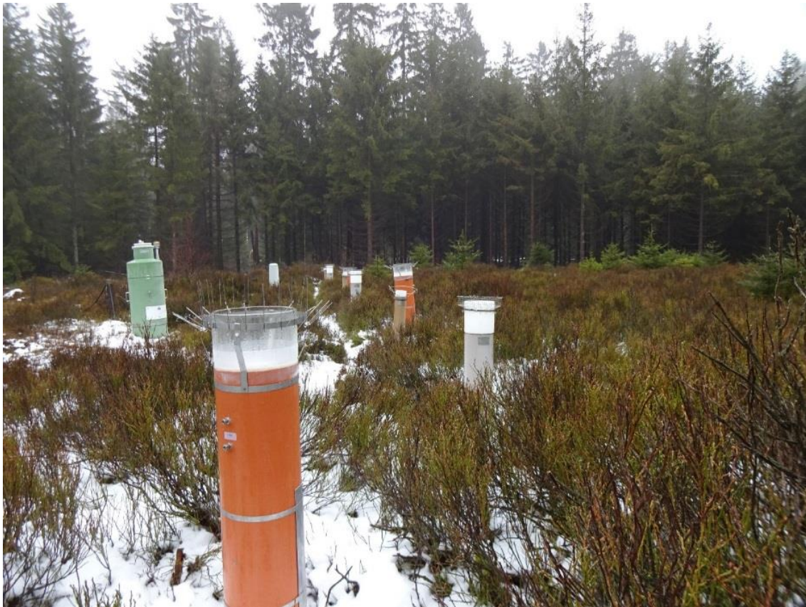
Abbildung 45: Hg-Sammler auf der Freifläche im Solling
