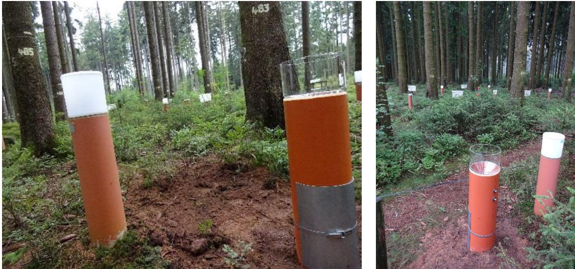
Abbildung 43: Hg-Sammler auf der alten Fichten-Versuchsfläche im Solling
