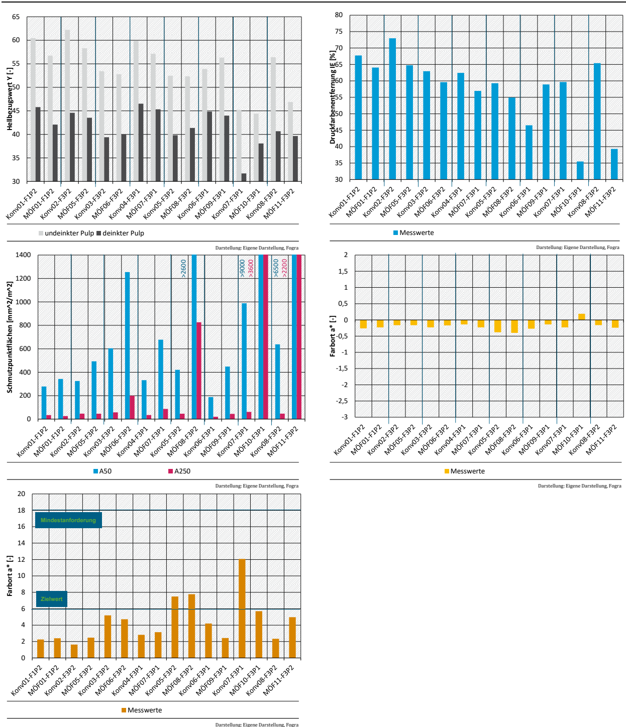
Abbildung 62: Vergleichende Ergebnisse aus den Deinkinguntersuchungen mit Druckprodukten aus mineralölfreien (MÖF) und konventionellen (Konv) Druckfarben, aufgeschlüsselt in die einzelnen Parameter zur Bewertung der Deinkbarkeit.
