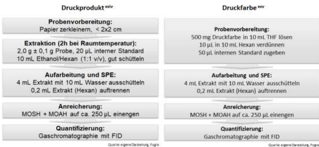
Abbildung 63: Schematisches Vorgehen zur Bestimmung von aliphatischen (MOSH) und aromatischen (MOAH) Kohlenwasserstoffen aus Mineralölen in Anlehnung an die BfR-Methoden xxiv, xxv . Es sind: SPE: Festphasenextraktion, FID: Flammenionisationsdetektor.
