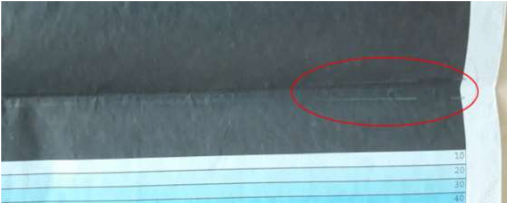
Abbildung 48: Abdrücke von Greifern aus dem Falzapparat (eigene Darstellung, Fogra).
