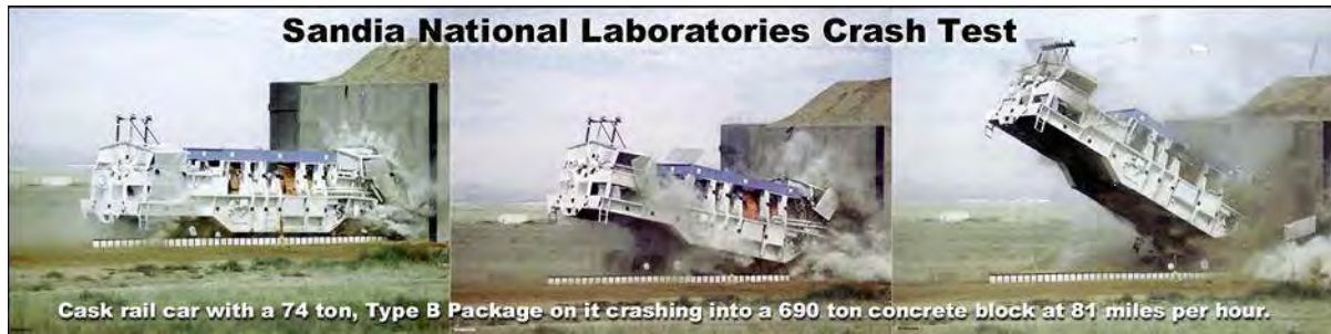
Abbildung 118. Ein Bahnwagen mit einem Behälter vom Typ B mit dem Gewicht von 74 Tonnen schlägt mit einer Geschwindigkeit von 130 km/h auf einem Betonblock mit dem Gewicht von 690 Tonnen auf. Bilder von den Tests im Sandia National Laboratories, dargestellt mit Genehmigung des Nuclear Energy Institute (USA).
