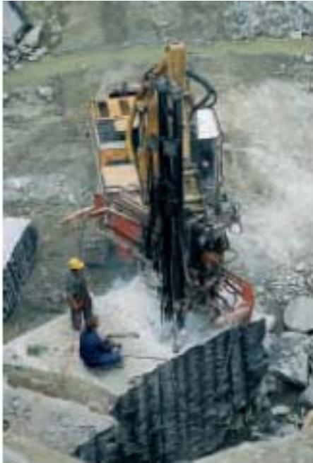
Abbildung 3-11: Herstellung gattergerechter Granitblöcke im Steinbruch Eitzing, Bayerischer Wald (aus /BSW 02/)
