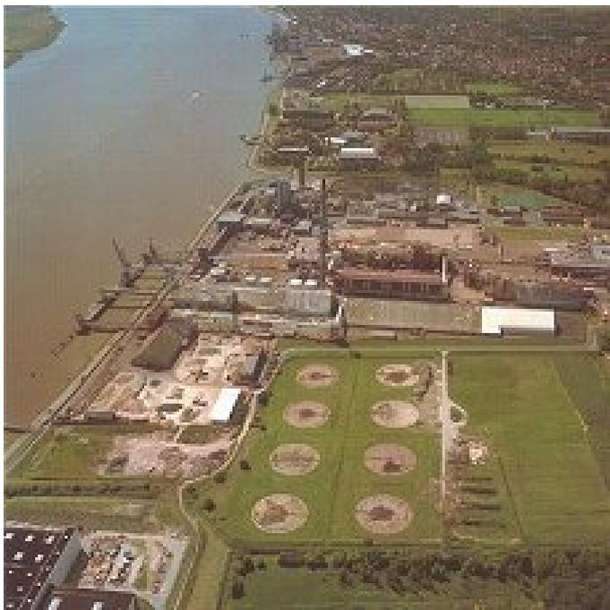
**Abb. 6:** Sanierte und rekultivierte Phosphat-Gips Deponie Nordenham
