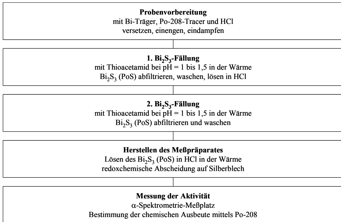
Abb. 1: Prinzip der Bestimmung von Po-210 im Trinkwasser
