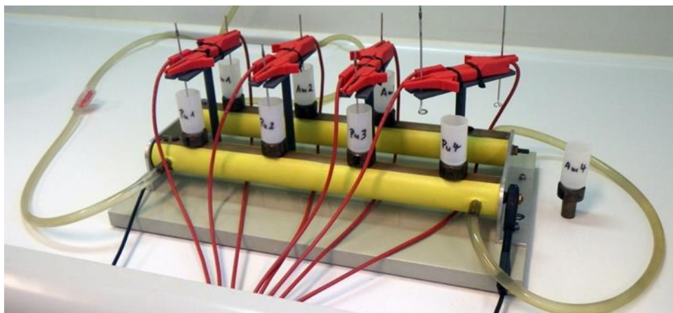
Abb. 3: Bild einer Apparatur für die Elektrodeposition
