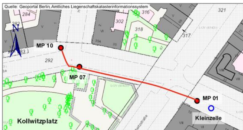
Bild 7.8: Kollwitzplatz: Abgelaufener Weg zur zeitabhängigen Darstellung der Sendeleistung vom Endgerät in Abhängigkeit von der Empfangsleistung des Kleinzellensignals.
