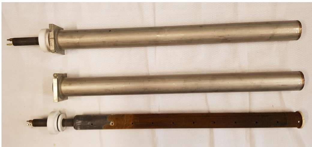
Abb. 4: Elektrolysezelle (oben) bestehend aus Anode/Außenteil (Mitte) und Kathode/Innenteil (unten)
