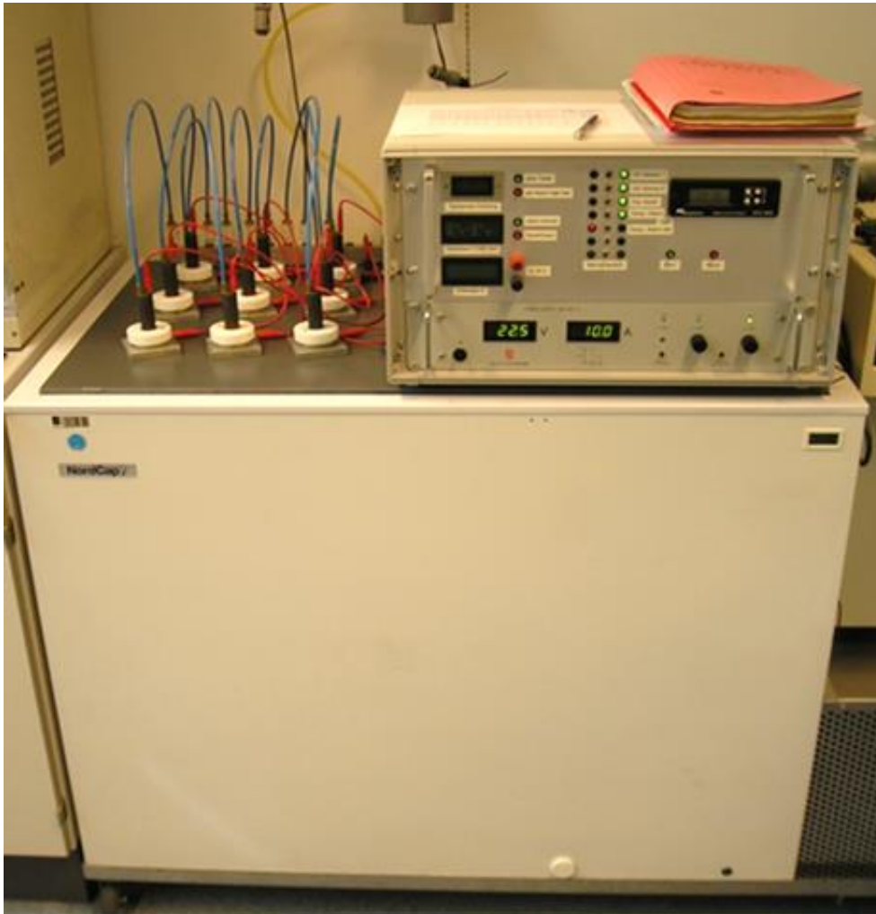
Abb. 3: Anreicherungsapparatur mit neun Elektrolysezellen
