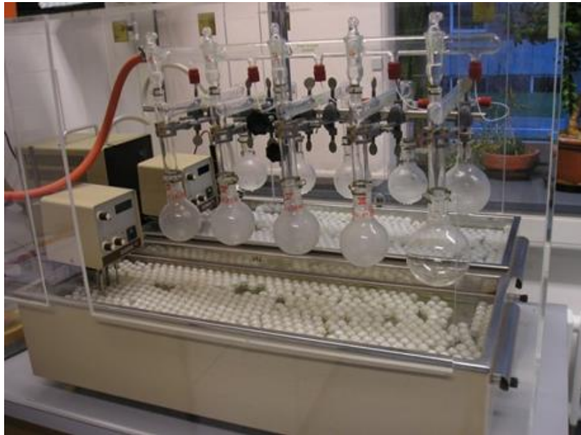
Abb. 1: Destillationsapparatur mit fünf Destillationseinheiten
