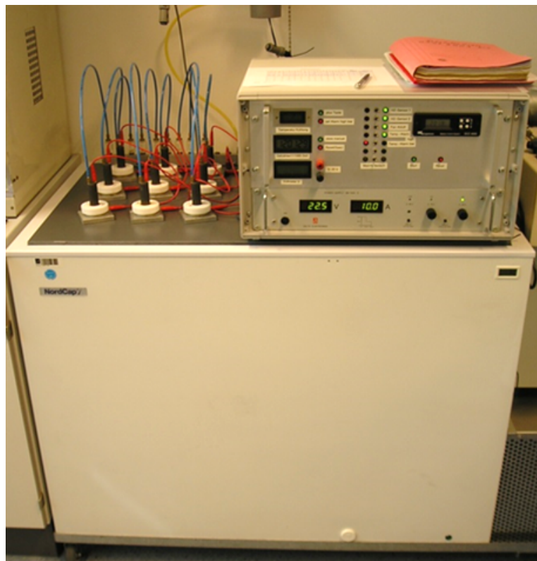
Abb. 4: Anreicherungsapparatur mit neun Elektrolysezellen
