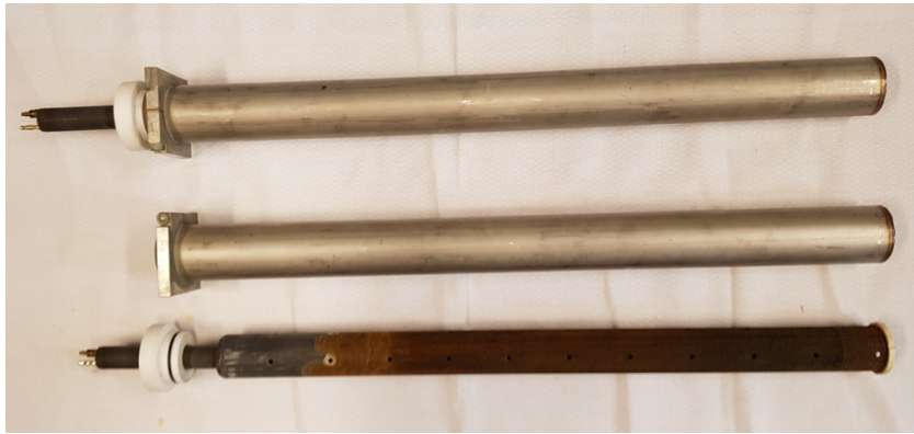
Abb. 5: Elektrolysezelle (oben) bestehend aus Anode/Außenteil (Mitte) und Kathode/Innenteil (unten)
