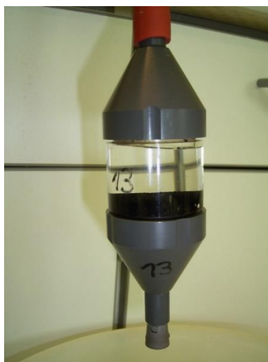
Abb. 5: Mit KCFC vorbereitete Ionenaustauschsäule
