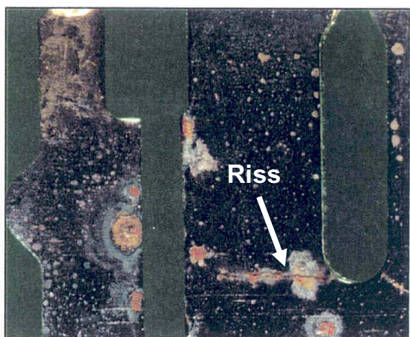
Bild 6.3-3: Spannungsrisskorrosion an einem nichtrostenden Stahl /6-4/
