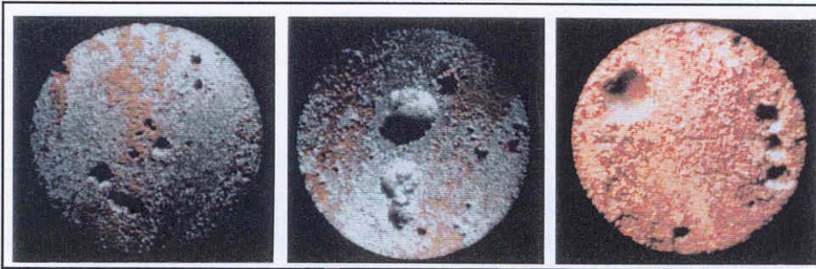
Bild 6.3-6: Loch- und muldenförmiger Korrosionsabtrag an einem nahtlosen Rohr aus dem Werkstoff 1.4571 /6-4/
