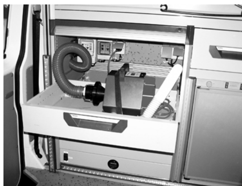
Abb. 5: Fest installierter Luftprobensammler im Probenahmefahrzeug
