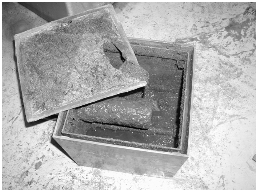
Abb. 1: Extreme Schwebstoffablagerungen in einer Messschale (Warnstelle Terborg)
