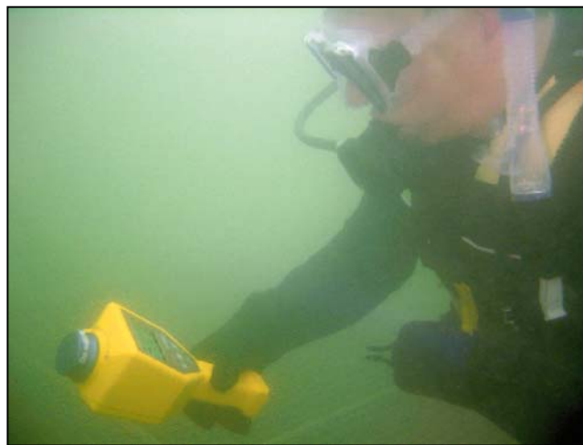
Abb.6: Tauchfähige Variante des identiFINDER® ultra, einsetzbar bis 10 m Wassertiefe
