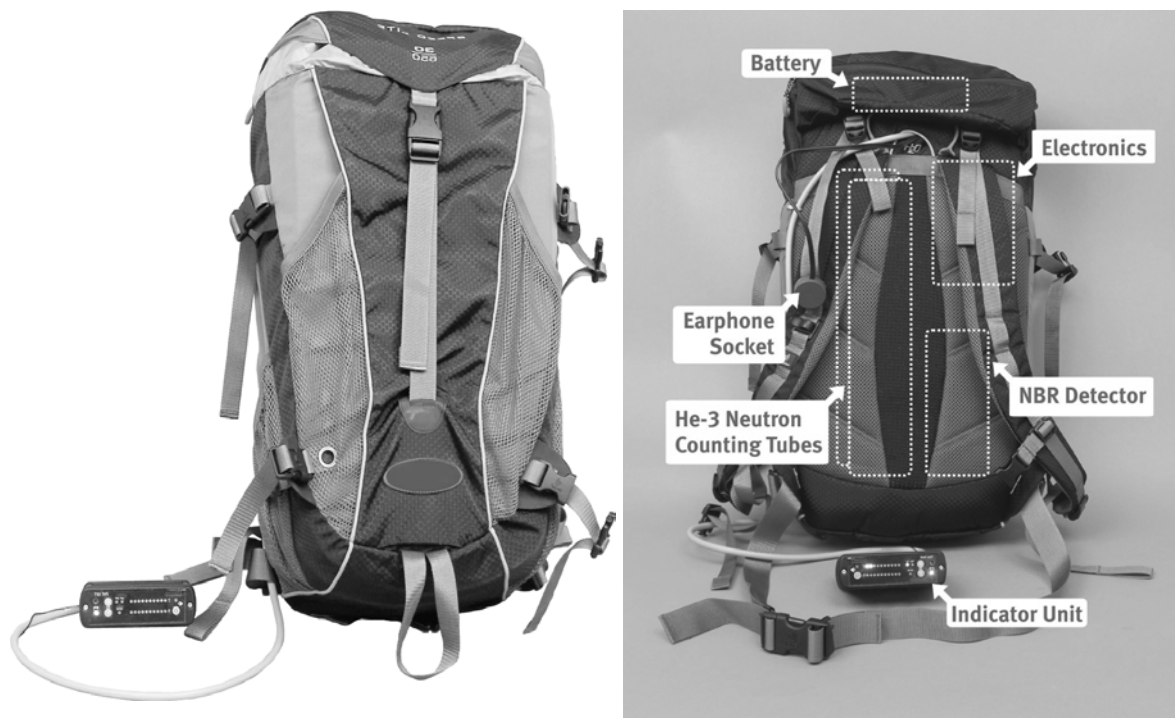
Abb. 3: Ansicht und Aufbau des Gamma- und Neutronenspürrucksacks FHT 1377
