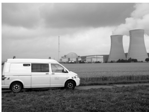
Abb. 4: Probenahmefahrzeug mit Sammler für Aerosole und gasförmiges Iod sowie zur Entnahme von Bewuchs-, Boden- und Wasserproben
