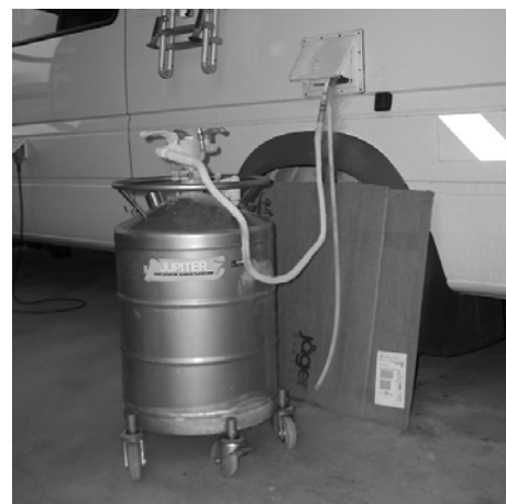
Abb. 13: Nachfüllsystem für Flüssigstickstoff für Germaniumdetektoren im Messfahrzeug
