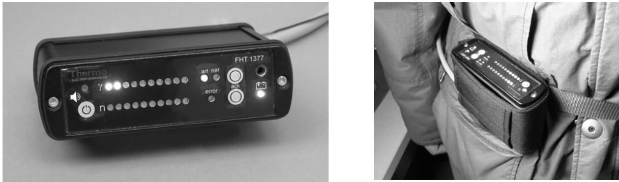
Abb. 5: Anzeigeeinheit des FHT 1377. Durch die verzögerungsfreie analoge Darstellung kann der Strahlungsintensität ermüdungsfrei auch aus den Augenwinkeln erfasst werden. Jede LED der Intensitätsskalen für Gamma (orange) und Neutronen (blau) kennzeichnet eine Verdoppelung des betreffenden Wertes. Darüberhinaus wird durch grüne bzw. rote LED der Charakter des Gammastrahlungsfeldes (natürlich bzw. künstlich) angezeigt.
